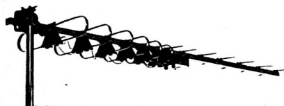
UHF-Breitbandantenne „4513 MD“ mit 6 gespeisten Dipolen (dipola)
